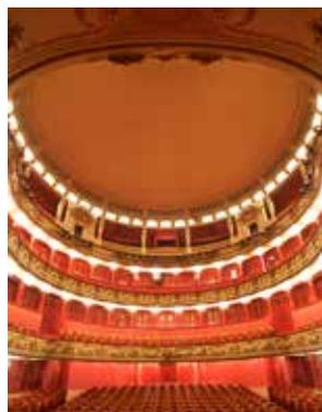
avec loges d'orchestre, d'un balcon, de deux galeries, d'un poulailler et d'un plafond plat « décollé ». Grâce à l'utilisation du béton pour sa construction, les balcons peuvent tenir sans colonnes, évitant ainsi de nombreuses places aveugles.
